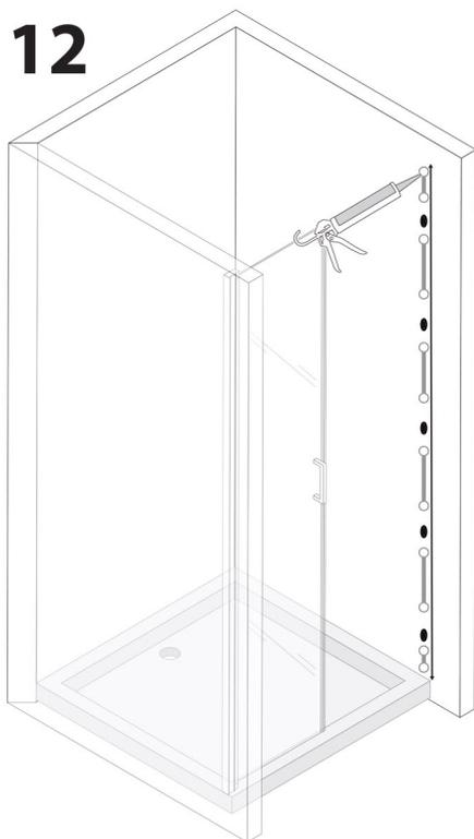
Appliquer du silicone / colle sur le mur entre les trous de perçage à l'aide d'un pistolet.
