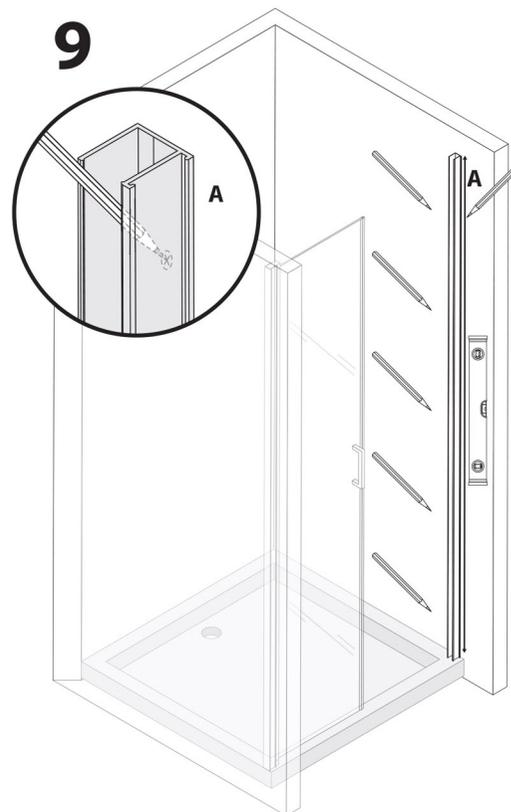
Aligner verticalement le profilé (rail - élément A) sur le mur à l'aide d'un niveau à bulle. Idéalement, le profilé mural doit être au contact du sol / ou du receveur de douche, de sorte qu'il n'y ait aucun espace excessif en bas.
